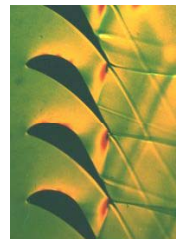
El color rojo es flujo supersónico, el amarillo transónico y el verde subsónico.
